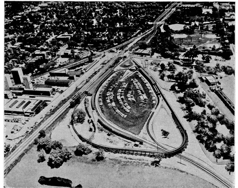
Abb. 29. Chicago. Station Desplains, Umsteigepunkt zwischen Schnellbahn (Garfield Route, Endstelle) und den Straßenbahn- und Omnibuslinien nach Westchester. Inmitten der Schleifen ein großer Parkplatz
